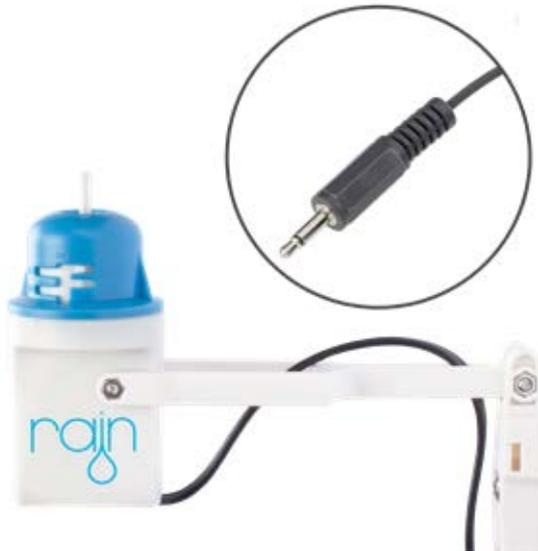
El sensor de lluvia funciona como un interruptor que detiene automáticamente el riego cuando se presenta un evento lluvioso de determinada entidad. Para ello, Acqua Jack utiliza discos higroscópicos que se hinchan en presencia de lluvia y vuelven a encogerse cuando se secan.
