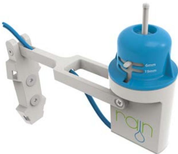
El sensor de lluvia funciona como un interruptor que detiene automáticamente el riego cuando se presenta un evento lluvioso de determinada entidad. Para ello, Acqua Jack utiliza discos higroscópicos que se hinchan en presencia de lluvia y vuelven a encogerse cuando se secan.
